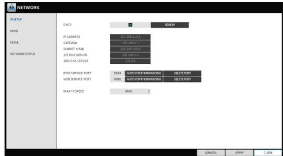
1. Navigieren Sie zum **<SYSTEM SETUP>** - **<NETWORK>** und wählen Sie **<IP SETUP>**.
