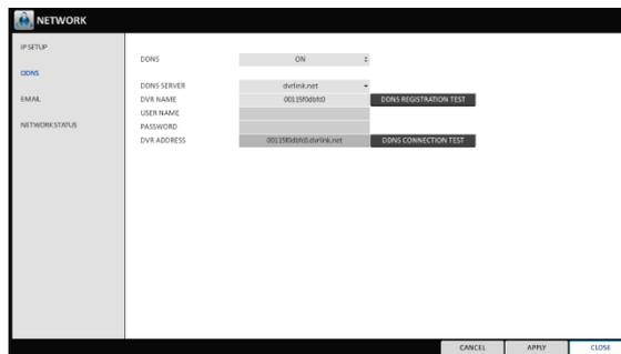
2. Nutzen Sie die Tasten **[▲ ▼ ◀ ▶ / ENTER]** auf der Fernbedienung oder die Maus, um die Verwendung des DDNS einzustellen und einen Server auszuwählen.
